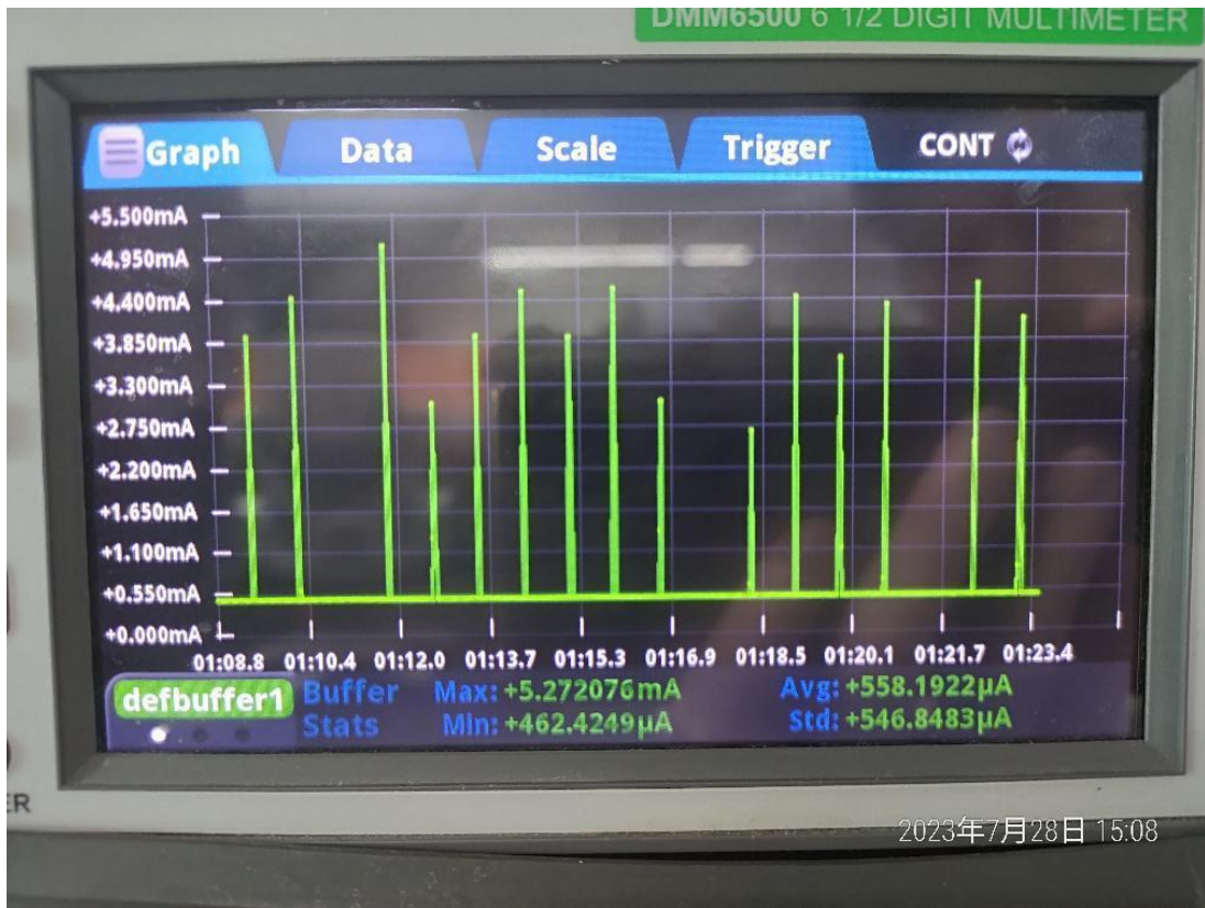
图 8 使能低功耗休眠状态下的工作电流图示
