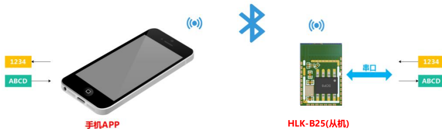
图 1 一对一蓝牙连接透传功能示意图
