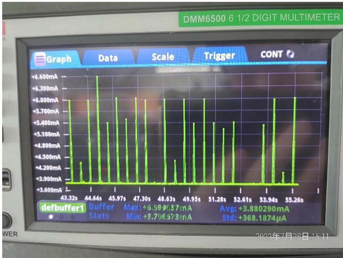
图 8 使能低功耗休眠状态下的工作电流图示
